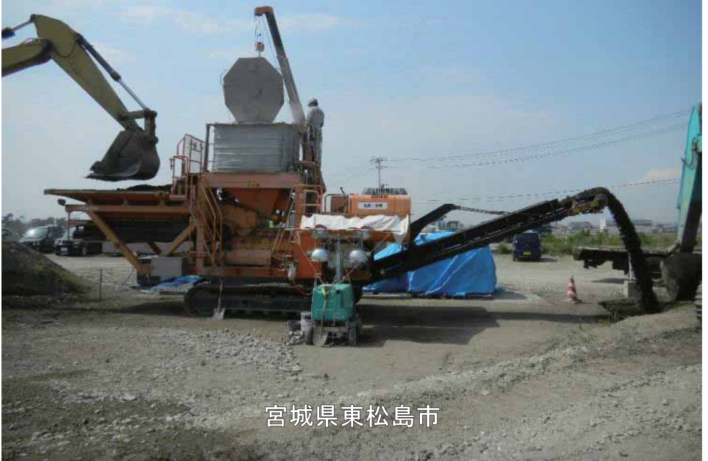
2607_4_018_044996_東松島市_2011.6.9_大曲浜災害廃棄物仮置場_土砂処理セメント混合
