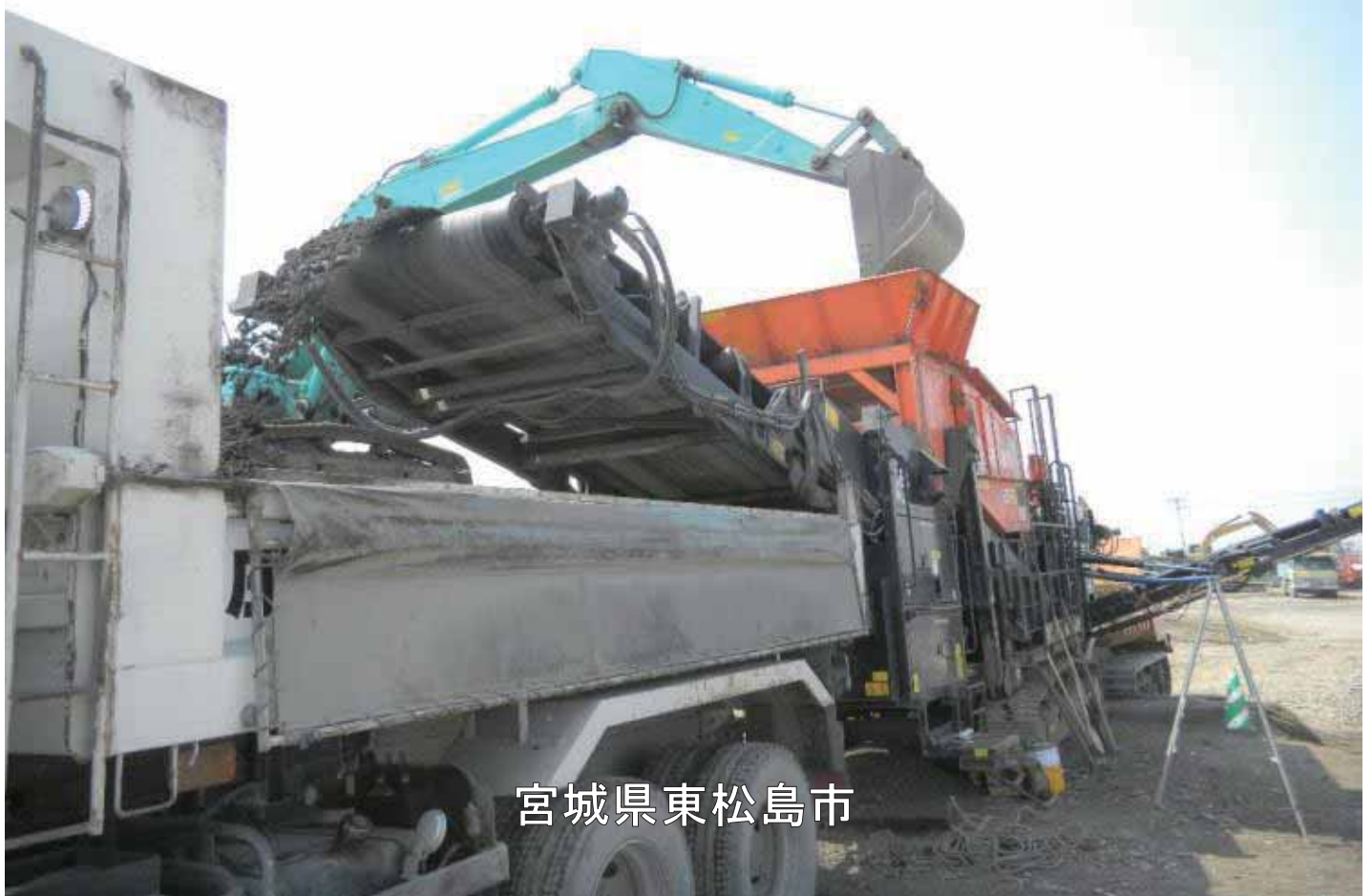
2607_4_018_044992_東松島市_2011.6.9 _大曲浜災害廃棄物仮置場_土砂処理機械分別
