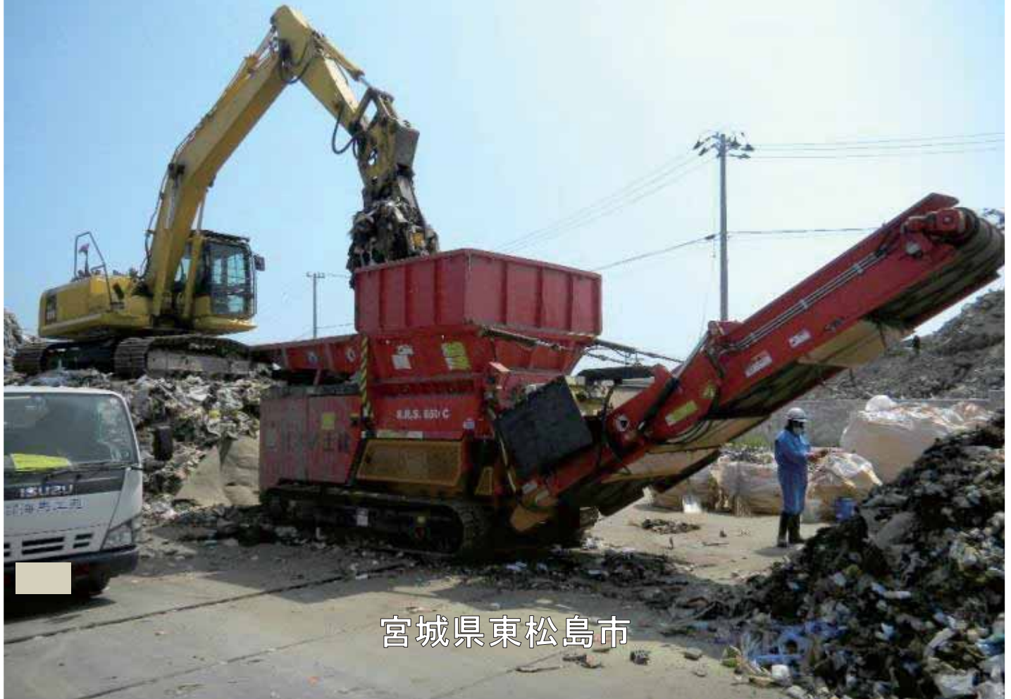
2607_4_018_044980_東松島市_2011.6.9_大曲浜災害廃棄物仮置場_混合ゴミ梱包
